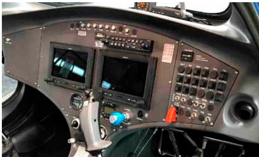
Příklad přístrojové desky Cavalon 915 s modrým ovládním vrtule (a dvojítm panelem Garmin G3x).
