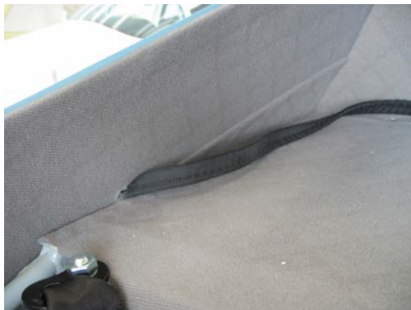
Fessura nel radome Radome slot
