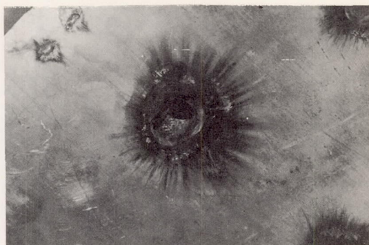
(d) Puncture of 0.040-inch sheet by 20-coulomb discharge.
